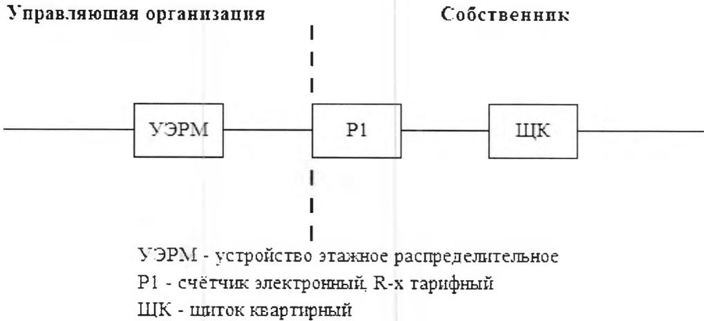
Исполнитель несет ответственность за надлежащее состояние и работоспособность питающих электрических сетей на квартиру согласно нижеуказанной схеме до прибора учета (пунктирной линии слева).
